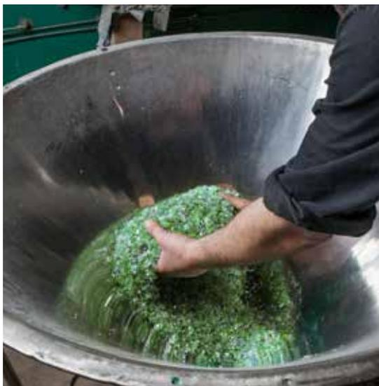
Les bouteilles PET passent dans un séparateur de métaux. Ceci permet d'exclure les étiquettes contenant de l'aluminium. Les bouteilles passent ensuite dans un broyeur qui les réduit à une grandeur de 12 mm.
