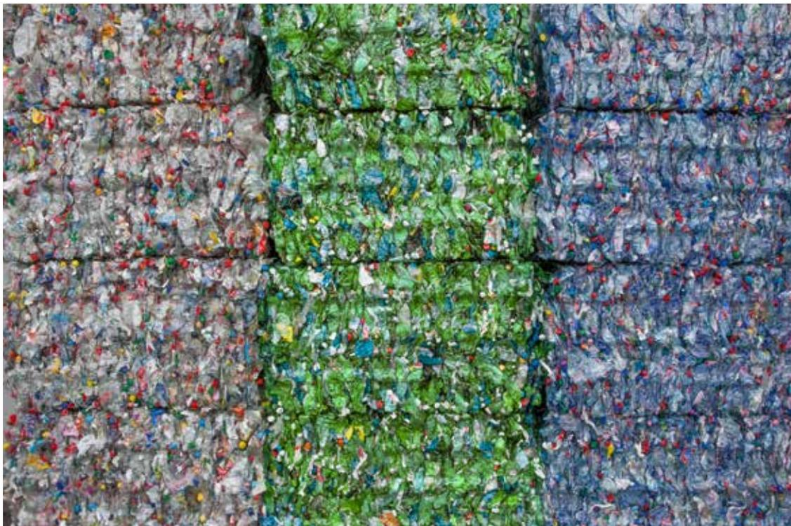
Les bouteilles PET collectées par Denner sont comprimées dans nos propres centres de distribution.
