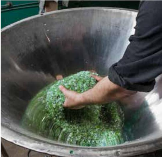
Die PET-Flaschen laufen über einen Metallabscheider. So werden auch Etiketten mit einem Aluminiumanteil ausgeschieden. Danach kommen die Flaschen in die Mühle, wo sie mit Messern auf 12mm Grösse geschnetzelt werden.
